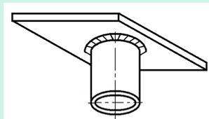
(4) 管材角焊缝试件
