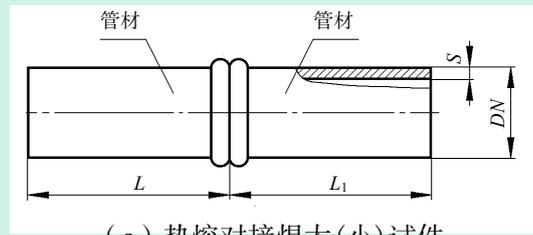
(a) 热熔对接焊大(小)试件
