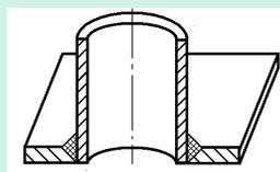
图 A-2 管板角接头试件接头形式
