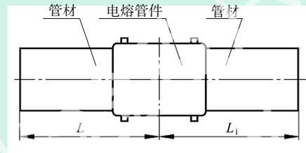
(c) 电熔连接焊承插试件
