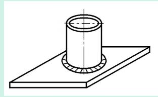
(b) 垂直固定平焊试件
