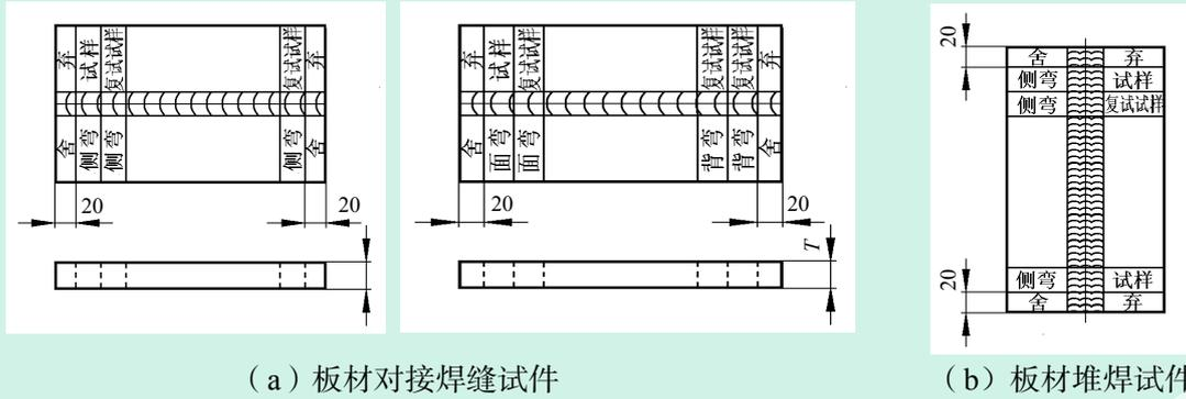
(a) 板材对接焊缝试件
