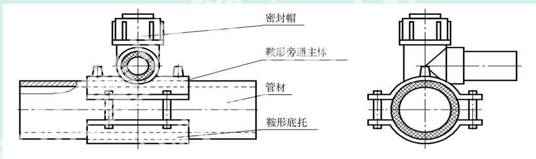
(d) 电熔连接焊鞍形试件(旁通式)
