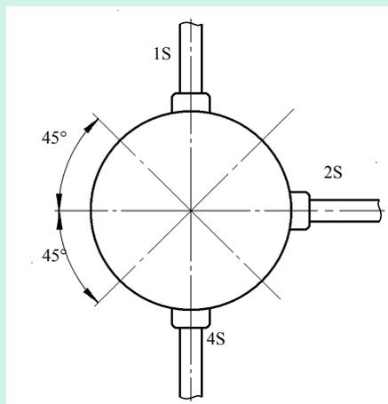
图 A-3 螺柱焊焊件焊接位置范围
