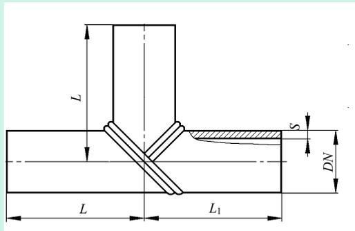
(b) 热熔对接焊三通试件
